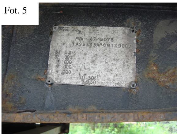
Fot. 5 Tabliczka znamionowa i numer identyfikacyjny VIN naczepy.
